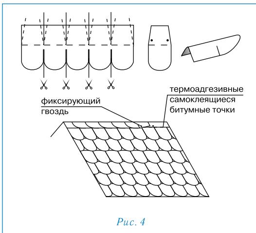
При укладке черепицы на скатах при уклоне больше  $60^{\circ}$  лист должен крепиться 6 гвоздями (2 дополнительных гвоздя фиксируют верхние углы листа на расстоянии от краев 2,5 см).
