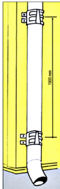
Расстояние между землей и концом водосточной трубы должно быть минимум 300 мм или же между отмосткой и трубой 150 мм.
